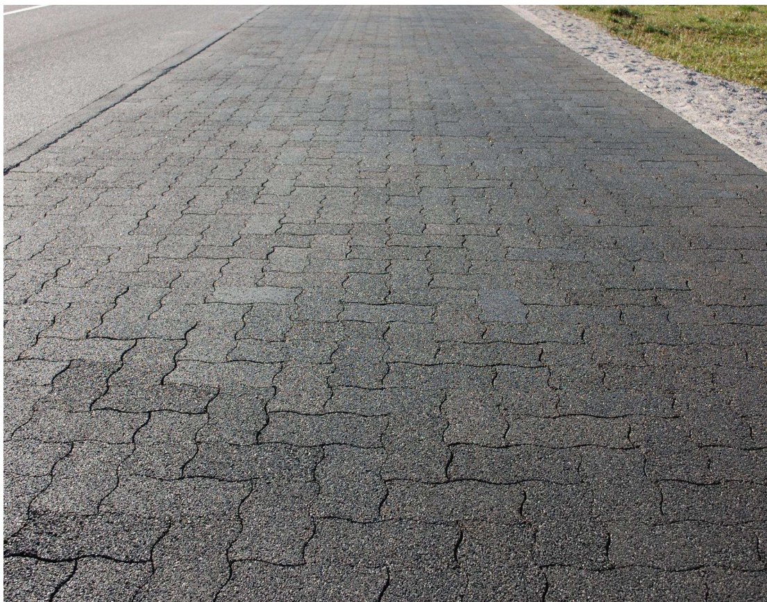
Рисунок 4 – Тестовий трек у Новій Гориці, Словенія, побудований у грудні 2014 року (довжина 20 м). Ця пороеластична бруківка виготовлена з плитки PERS, наклеєної на цементобетонні блоки.
