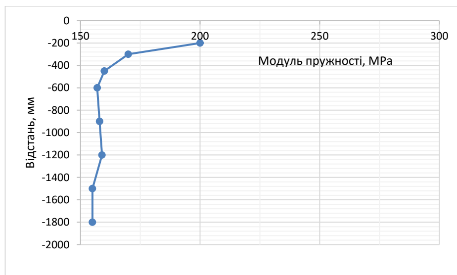
Рисунок 7 – Чаша прогину, яка побудована за результатами вимірювань методом FFWD (зразок)
