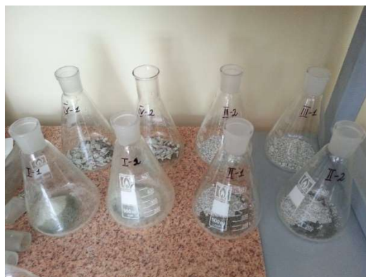
Figure 3 – Use of zeolite samples of different fractions for simulation of surface runoff Рисунок 3 – Використання зразків цеолітів різних фракцій для моделювання поверхневих стоків
