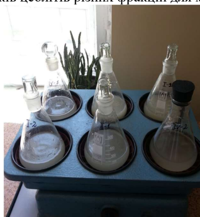
Figure 3 – Use of zeolite samples of different fractions for simulation of surface runoff Рисунок 3 – Використання зразків цеолітів різних фракцій для моделювання поверхневих стоків
