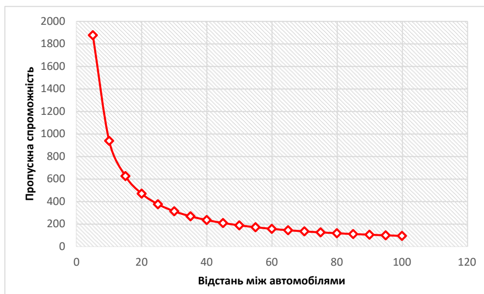
Рисунок 5 – Залежність зміни пропускної спроможності від відстані між автомобілями. Figure 5 – Dependence of the coefficients of adhesion \varphi and rolling resistance f on the thickness of unconsolidated snow h_{sn} on the pavement.
