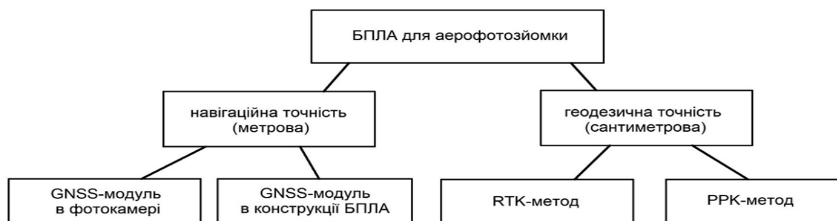
Рисунок 1 – Модифікації БПЛА за принципом визначення координат центрів знімків Figure 1 – UAV modifications based on the principle of determining the coordinates of the photo centers
