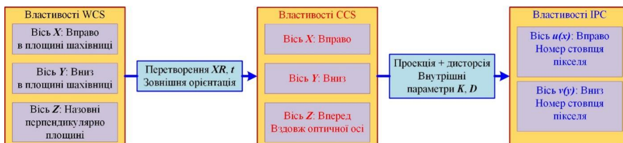
Рисунок 2 – Ланцюжок перетворень при фотограмметричному калібрування камери Figure 2 – Transformation chain for photogrammetric camera calibration
