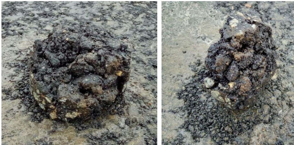
Рисунок 4 – Керн шару покриття з виявленим температурним дефектом Figure 4 - The core of the pavement layer with the detected temperature defect
