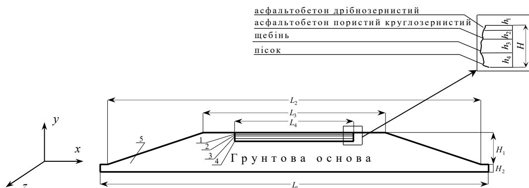
Рисунок 3 – Схема поперечного перерізу конструкції дорожнього покриття
