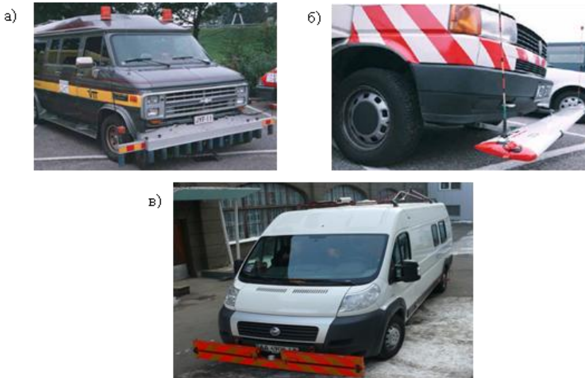
а) профілограф «Roadmaster», Фінляндія; б) установка «TUS», Франція, в) ЛВС 2 ХНАДУ
