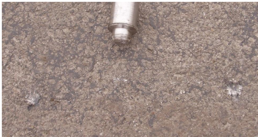
Рисунок 8 – Лунки, що утворились на покритті, після серії ударних навантажень індентором R = 42 мм
