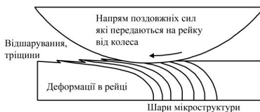
Рисунок 4 – Наслідки збільшення сили тяги одиночної колісної пари, зміщення волокон поверхні контакту рейки та колеса
