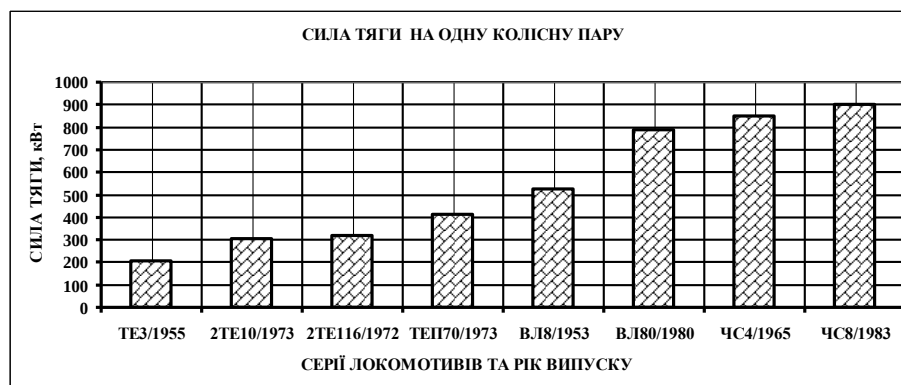
Рисунок 5 – Сила тяги одного колісно-моторного блоку локомотива
