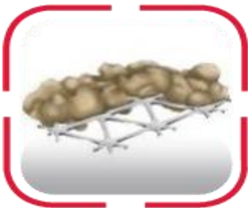
Рисунок 5 – Принцип розподілу навантажень тривісною георешіткою
