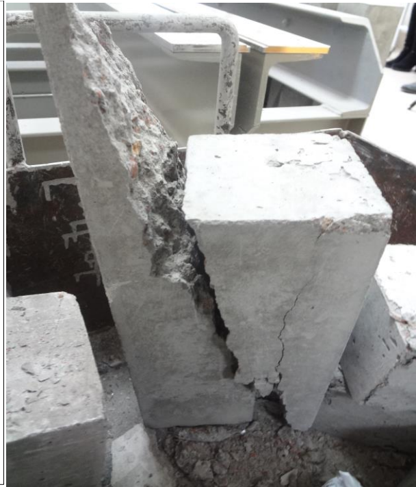
Рисунок 6 – Характерне руйнування зразка – призми
