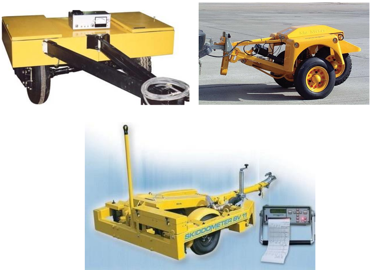
Рисунок 1 - Засоби вимірювання коефіцієнта зчеплення на аеродромах України
