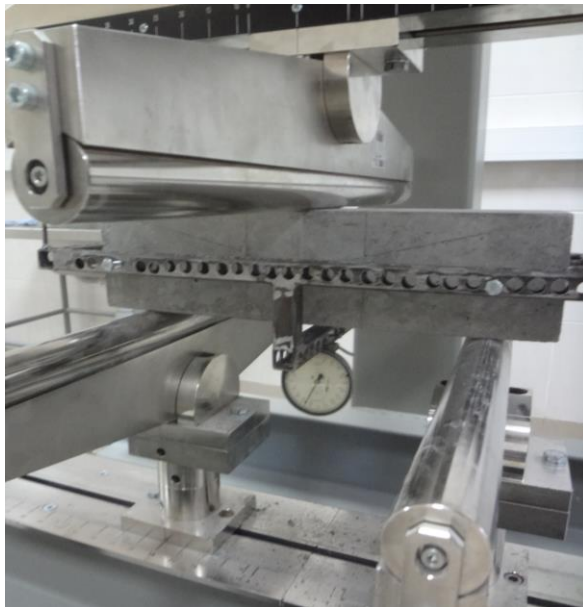
Рисунок 7 – Загальний вигляд при випробуванні цементобетонної призми на розтяг при згині Рисунок 8 – Діаграма “напруження деформація”
