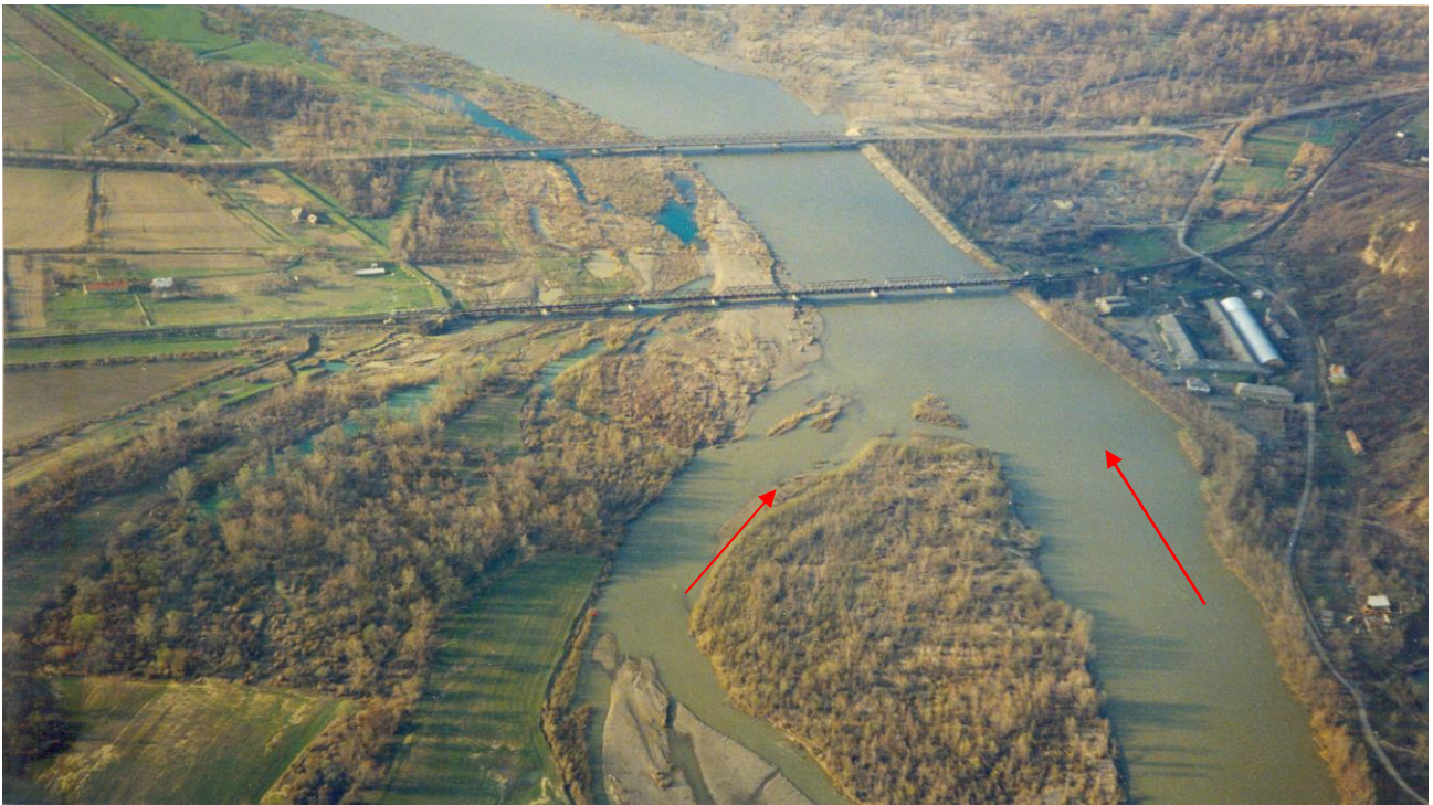
Рисунок 2 – Загальна картина протікання води та розташування акумулятивних форм на р.Тиса біля м. Виноградів на ділянці з існуючими залізничним і автодорожнім мостами (залізничний міст розташовано вище за течією)
