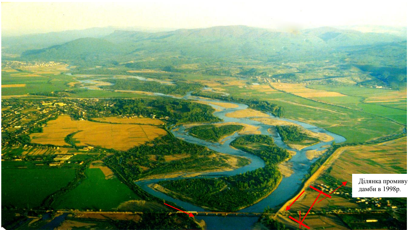
Рисунок 4 – Загальна картина протікання води та розташування акумулятивних форм на р. Тиса біля смт Вишково: на передньому плані автодорожний міст перед яким сформувався острів; вище моста три острови та чотири протоки, ще вище – нові скупчення донних гравійно-піщаних наносів без рослинності (осередки), а потім знову острів і дві протоки
