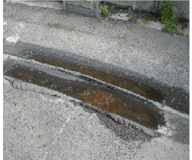
Рисунок 11 - Вигляд карти з холодного асфальтобетону типу Вх після 3000 обертів стелю
