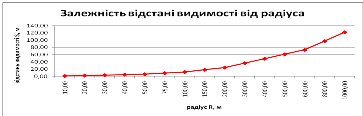
Рисунок 2 – Відстань видимості поверхні дороги на горизонтальних кривих
