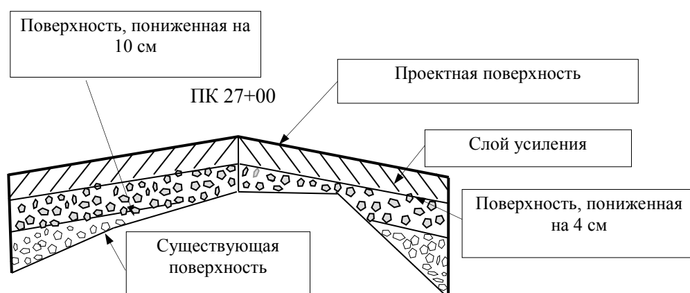
Рисунок 1 – Разрез поверхности на ПК 27+00 с границами выравнивающих слоев
