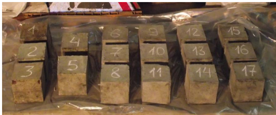
Рисунок 2 – Визначення міцності бетону на стиск руйнівним методом
