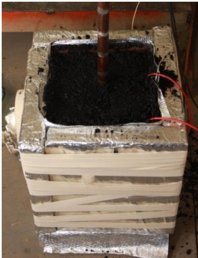
Рисунок 3 – Моделювання остигання асфальтобетонної суміші в теплоізольованій формі при проведенні експерименту
