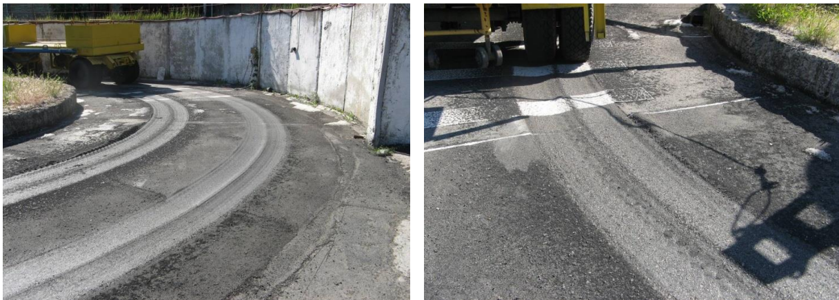
Рисунок 10 – Вигляд покриття з асфальтобетону армованого мікрОВОЛОКНАМИ КС- 12 після 6400 обертів стенду
