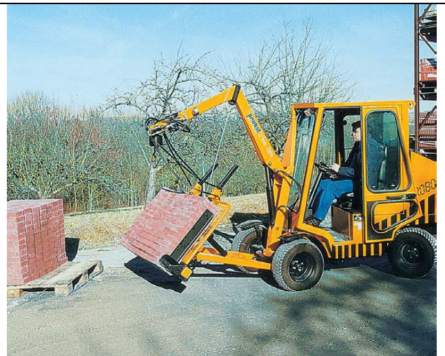
Транспортування блоків мощення обладнанням PC-VM-uni
