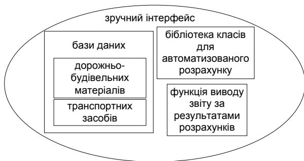
Рисунок 1 – Структура програми по автоматизованому розрахунку дорожнього одягу нежорсткого типу УКРРДО 16
