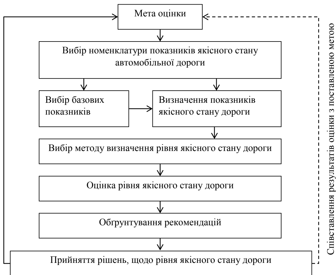
Рисунок 1 – Структурна схема визначення рівня якісного стану автомобільної дороги
