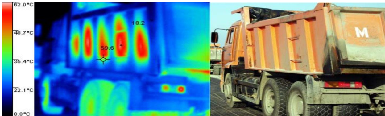
Рисунок 3 – Нерівномірність остигання суміші в кузові автомобіля
