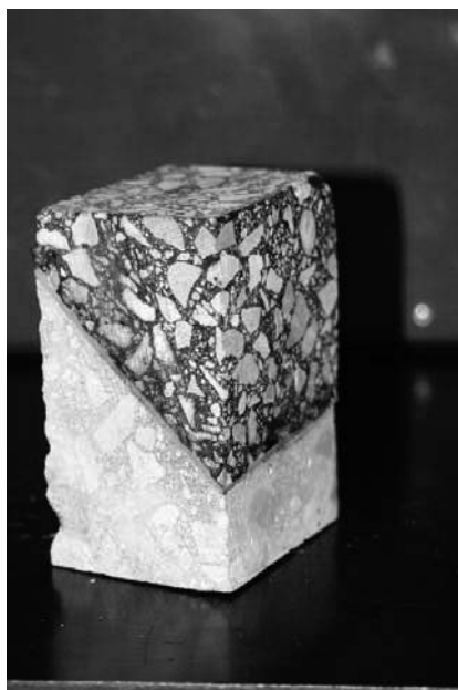
Рис. 2. Образец-призма для испытания на сдвигоустойчивость системы: бетон – гидроизоляция - литой асфальтобетон
