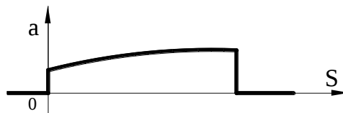
Рис. 5. Зміна відцентрового прискорення при поєднанні прямолінійної ділянки запроектованої прямою та криволінійної – параболою
