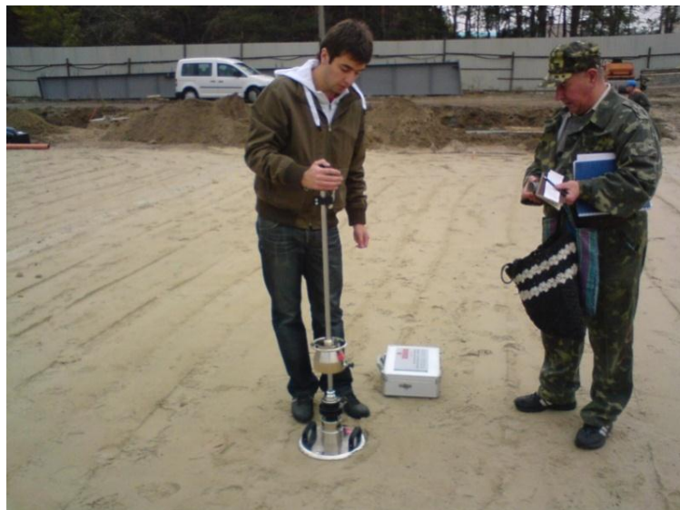
Рис. 1. Визначення динамічних модулів пружності приладом ZFG 02
