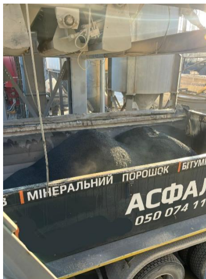
Рисунок 1 – Додавання енергозберігаючої добавки та виготовлення суміші Figure 1 – Addition of an energy-saving additive and production of the mixture
