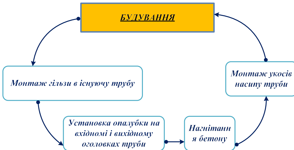
Рисунок 4 – Етап будування при підсиленні пошкодженої залізобетонної труби Figure 4 – Stage of construction when a damaged reinforced concrete pipe is reinforced
