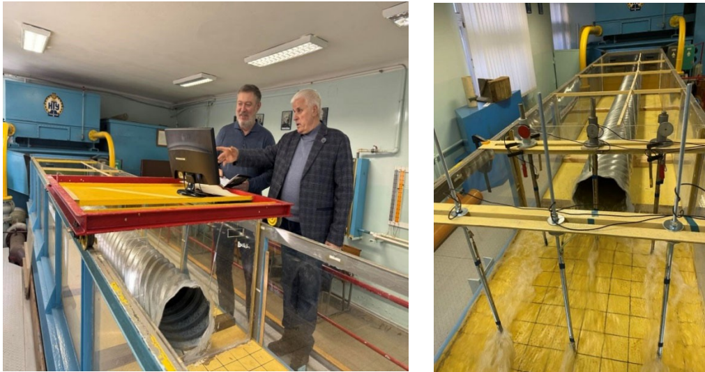
Рисунок 6 – Процес дослідження гідравлічних характеристик металевих гофрованих труб Figure 6 – The process of researching the hydraulic characteristics of metal corrugated pipes
