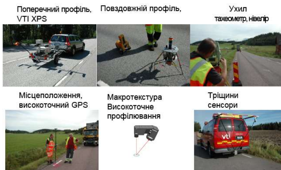
Рисунок 2 – Різні види обладнання, що використовуються для визначення параметрів автомобільних доріг у Швеції [17].
