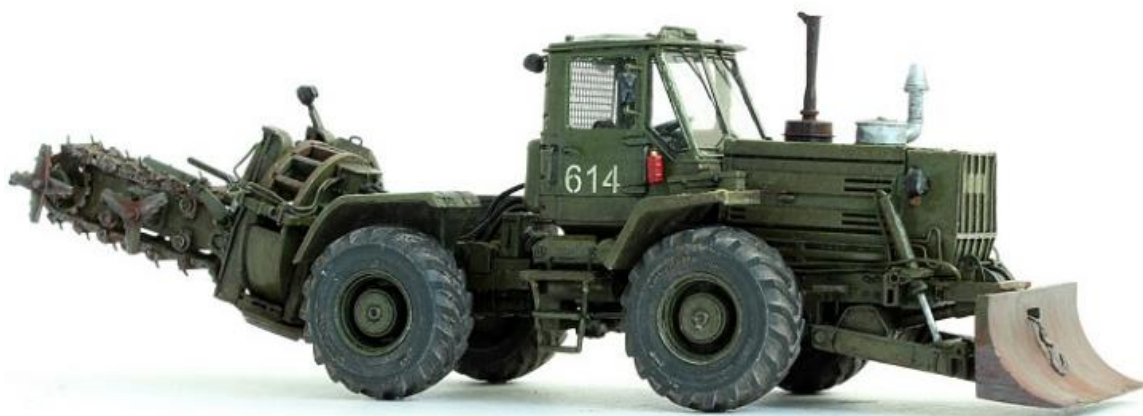
Рисунок 1 – Полкова землерийна машини ПЗМ-2 Figure 1 – PZM-2 Battalion Earthmoving Machine
