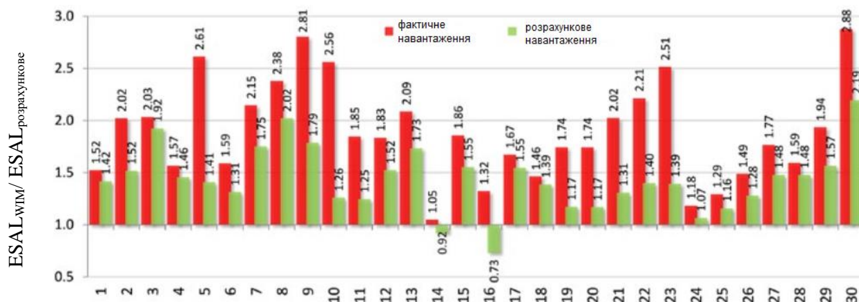
Рисунок 11 – Різниця розрахункових та вимірних навантажень на дорожній одяз [6] Figure 11 – The difference between calculated and measured loads on road surfaces [6]
