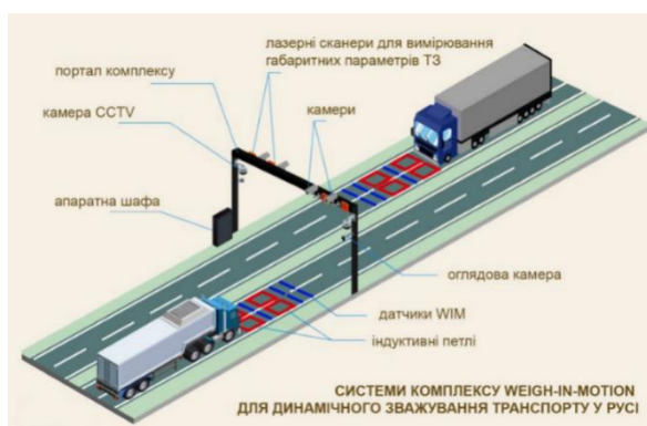
Рисунок 8 – WIM система на основі смуг Figure 8 – WIM system based on strips
