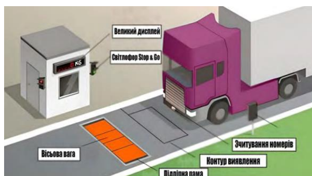
Рисунок 6 – LS-WIM система на основі пластин Figure 6 – LS-WIM plate-based system [5]
