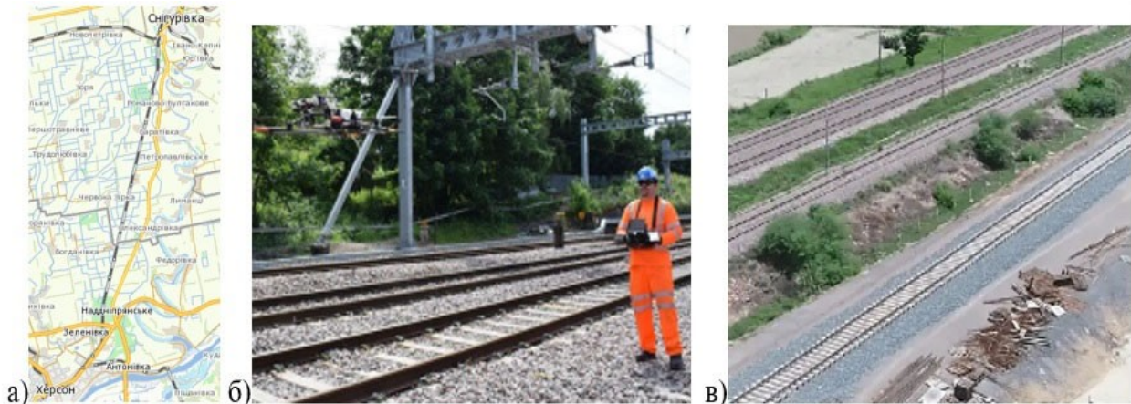
Рисунок 5 – а) - Схематичне зображення досліджуваної ділянки залізничного маршруту (Херсон-Снігурівка), б) - підготовка БПЛА до моніторингу колії, в) – вигляд колії з БПЛА
