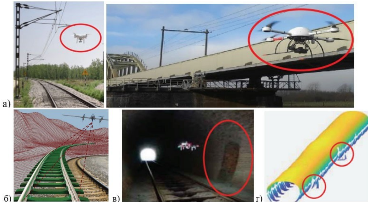
Рисунок 6 – а) - проведення моніторингу залізничної колії та мосту за допомогою БПЛА, б) - оцінка якості залізничної колії, в) - огляд тунелю, г) - тривимірне моделювання досліджуваного тунелю
