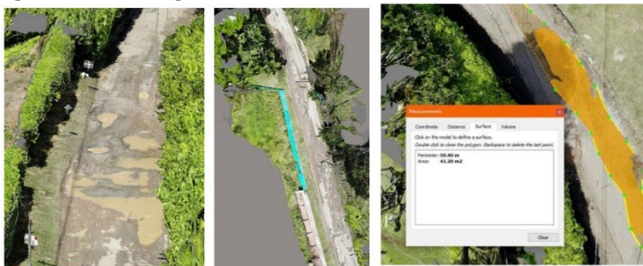
Рисунок 3 – Вид пошкодженої ділянки дороги з БПЛА, що створені на основі зображень, отриманих за допомогою БПЛА
