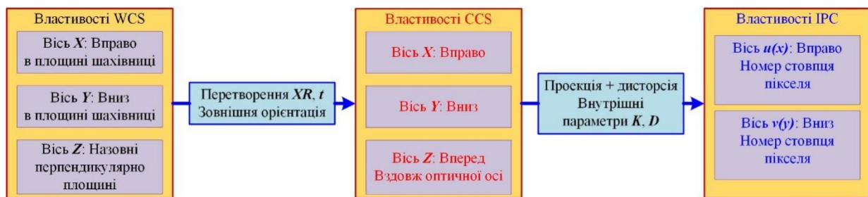
Рисунок 2 – Ланцюжок перетворень при фотограмметричному калібрування камери Figure 2 – Transformation chain for photogrammetric camera calibration
