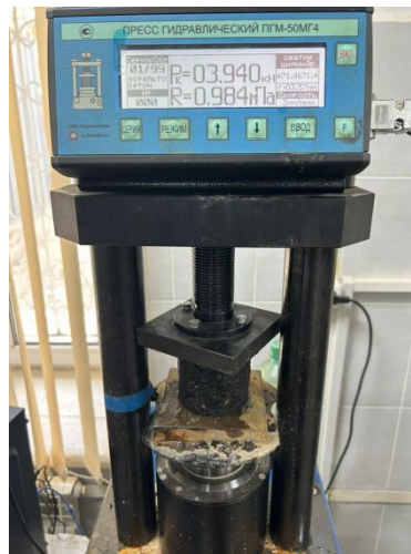
Рисунок 3 – Випробування міцності при стиску Figure 3 – Compressive strength testing
