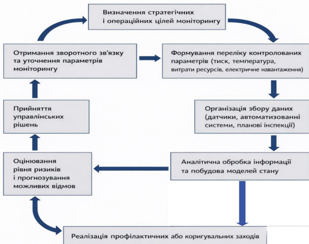
Рисунок 1 – Схема організаційно-технологічного моніторингу інженерних мереж
