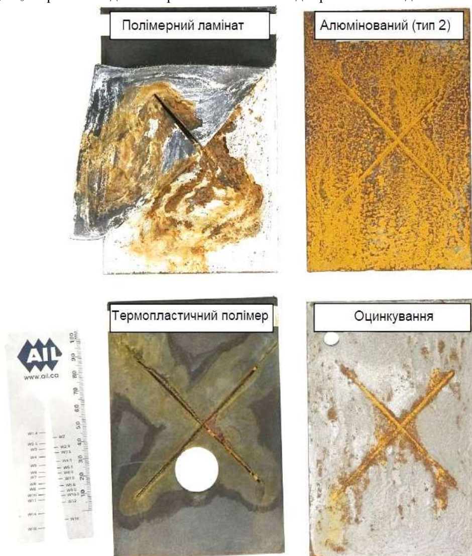
Рисунок 5 – Оцінювання впливу корозії на захисне покриття
