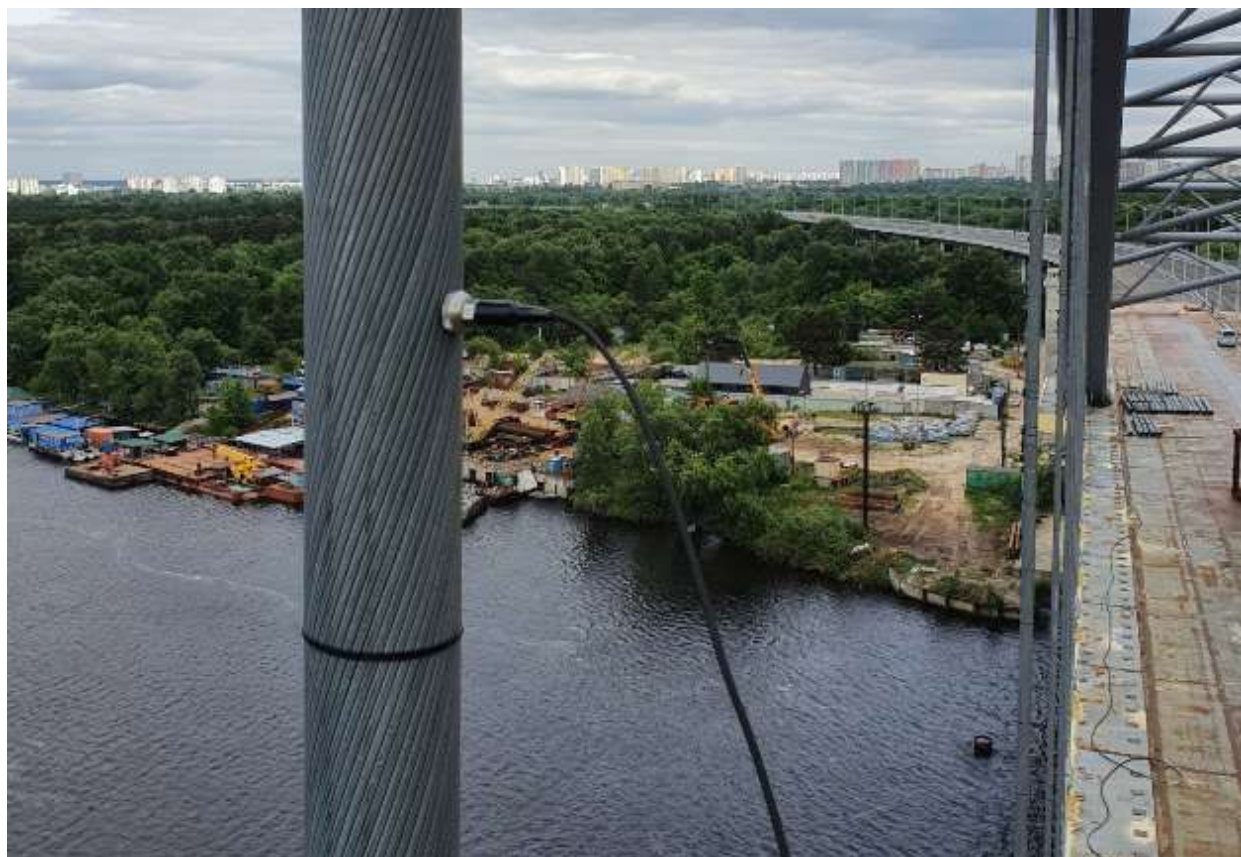
Рисунок 2 – Давач динамічних коливань встановлений на канаті
