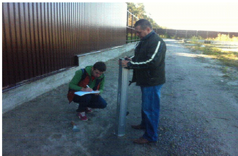
Рисунок 3 – Проведення випробувань по вимірюванню динамічного модуля пружності (ділянка 1, INSPECTOR 3)
