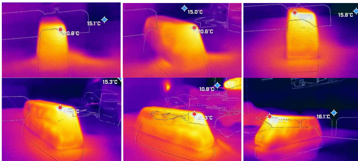
Рисунок 4 – Теплове поле моделі автобуса: різні етапи термодинамічного випробування. Figure 4 – Thermal field of a bus model: different stages of thermodynamic testing.
