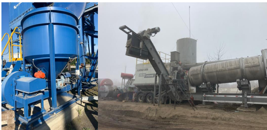
Рисунок 2 – Дозатор целюлози і мобільний АБЗ Figure 2 – Cellulose feeder and mobile asphalt mixing plant
