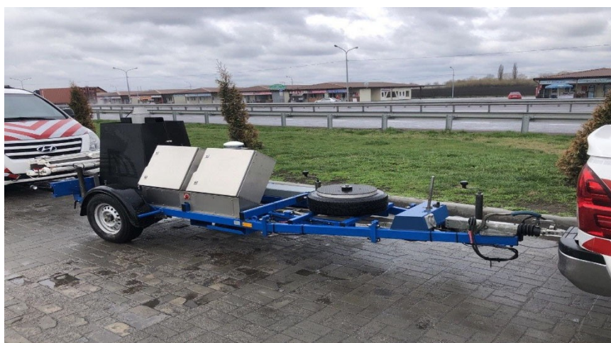
Рисунок 1 – Устаткування для оцінки міцності за методом FFWD [7]
