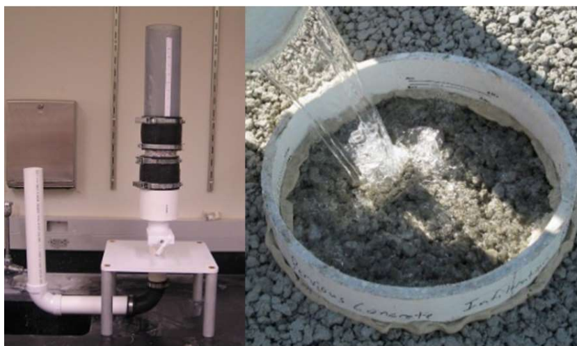
Рисунок 4 – Методи вимірювання інфільтраційних властивостей проникного цементобетону а – лабораторним пермеаметром; б – польовий метод
