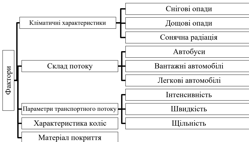
Рисунок 1 – Фактори, що впливають на зношування дорожнього покриття
