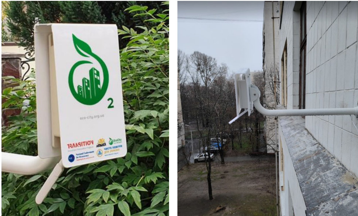
Рисунок 4 – Універсальна станція моніторингу якості повітря «Оxygen» Figure 4 – Universal air quality monitoring station «Oxygen»
