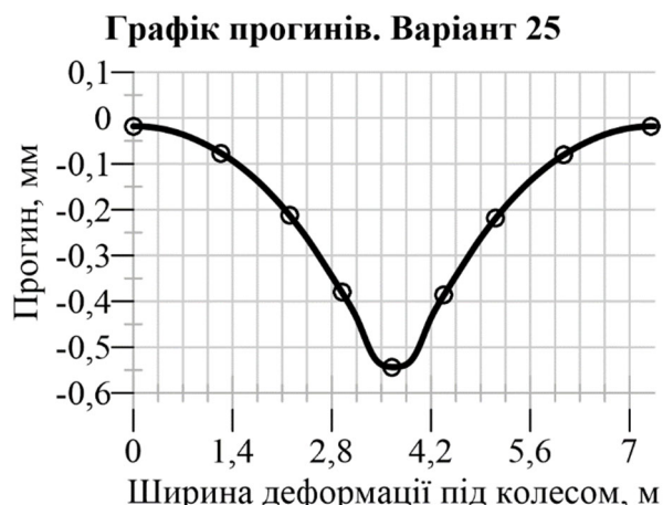
Рисунок 11 – Варіант 25. Чаша прогину Figure 11 – Option 25. Deflection cup
