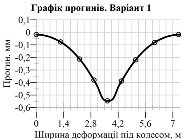
Рисунок 10 – Варіант 1. Чаша прогину Figure 10 – Option 1. Deflection cup
