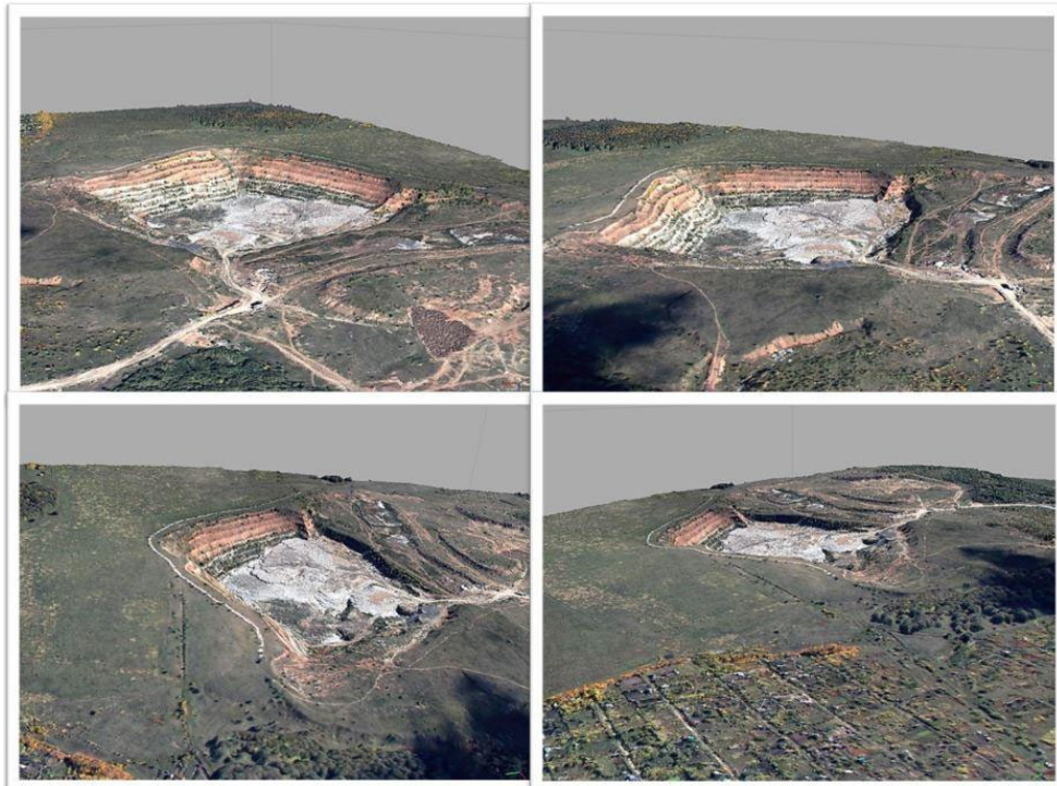
Рисунок 4 – Просторове моделювання змін рельєфу кар'єру за результатами геодезичного лазерного сканування місцевості [17]
