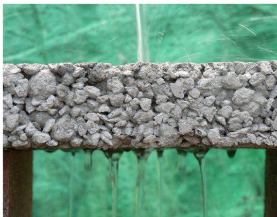
Рисунок 1 – Загальний вигляд дренажного бетону
