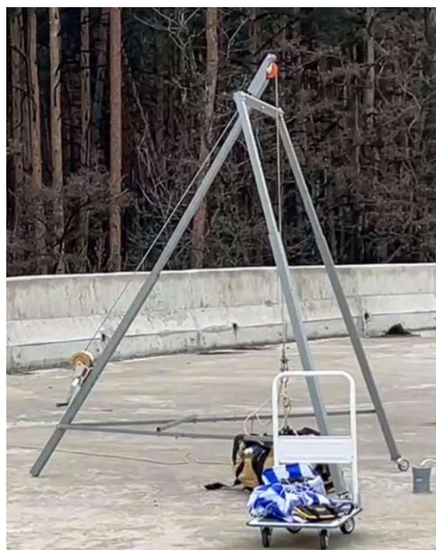
Рисунок 2 – Лебідка для скидання вантажу Figure 2 – Load-dropping device
