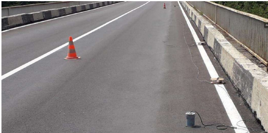
Рисунок 4 – Сейсмоприймачі ОСП-2МВ на проїзній частині у прогонах 5-6 та 6-7 Figure 4 – Seismometers OSP-2MV placed on the roadway in spans 5–6 and 6–7
