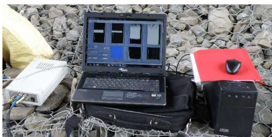
Рисунок 1 – Обладнання на базі АЦП ADA-1406
