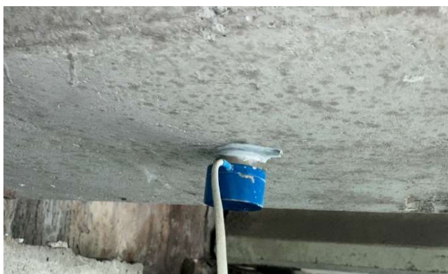
Рисунок 6 – Встановлення перетворювача акустичної емісії на балці за допомогою неодимового магніту
