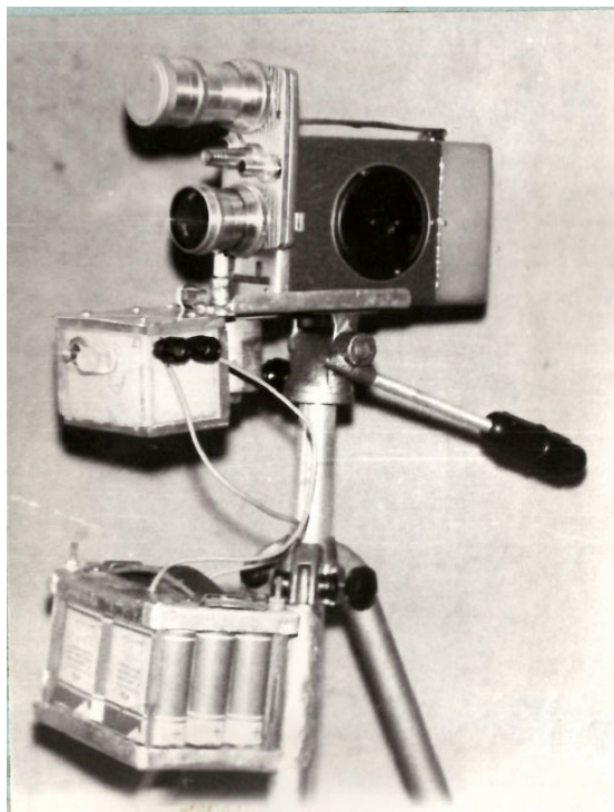
Рисунок 5 – Кінокамера «Київ-16с» з блоком для кінематометричного методу вивчення руху транспортних потоків
