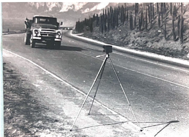
Рисунок 1 - Переносний лічильник руху ПДС-1 Figure 1 - Portable traffic counter PDS-1
