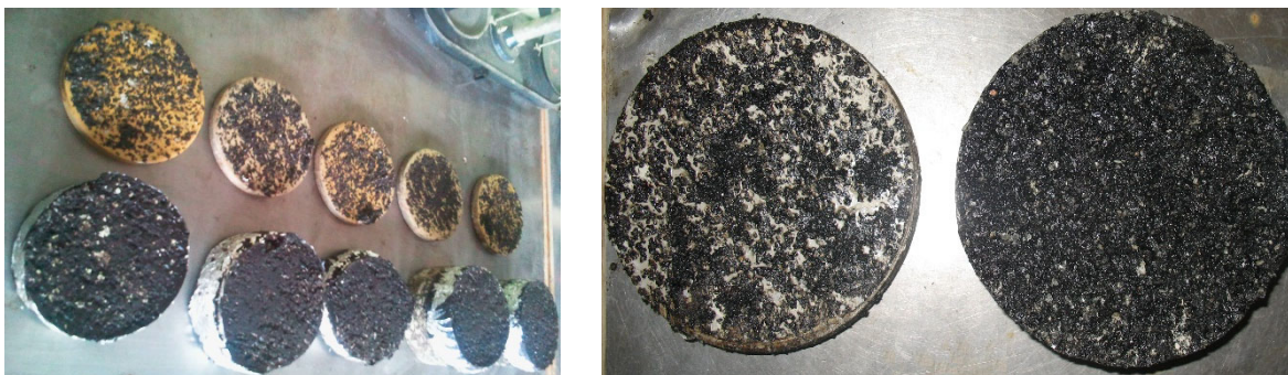
Рисунок 5 – Система: метал, П, МВ, А, посипка щебенем з витратою 800 г/м 2 , ГА Figure 5 – System: metal, P, MV, A, crushed stone sprinkling with a consumption of 800 g/m 2 , GA
